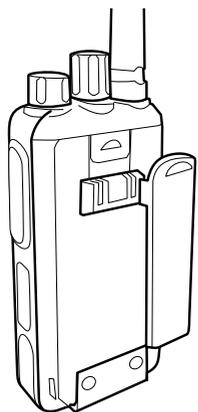
3. **Instalando o fone de ouvido:** remova a borracha de proteção localizada na parte lateral do radiocomunicador e conecte o fone de ouvido.
