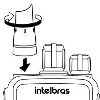
2. **Instalando o suporte de cinto:** encaixe o suporte de cinto no encaixe localizado na parte traseira da bateria.
